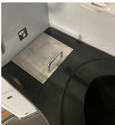
Upprustning Coradia X62. Bild 3: Ny soplucka WC. Bild 2: Nytt golv i bistro.
